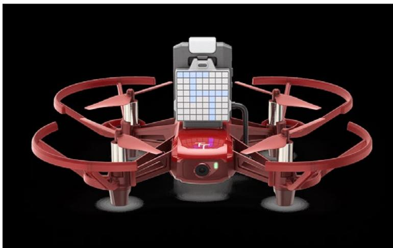
**Рис. 15.** Вид учебной летающей робототехнической системы с CV камерой
