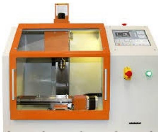
**Рис. 10.** Вид фрезерного станка
