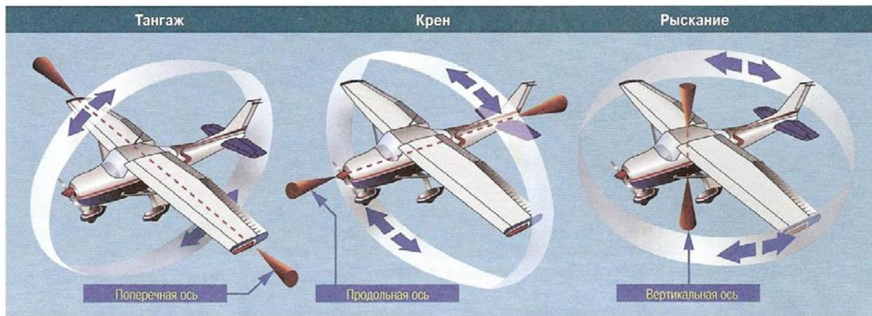
**Рис. 118.** Параметры полёта самолёта
