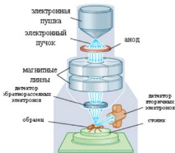
**Рис. 112.** Принципиальная схема сканирующего электронного микроскопа
